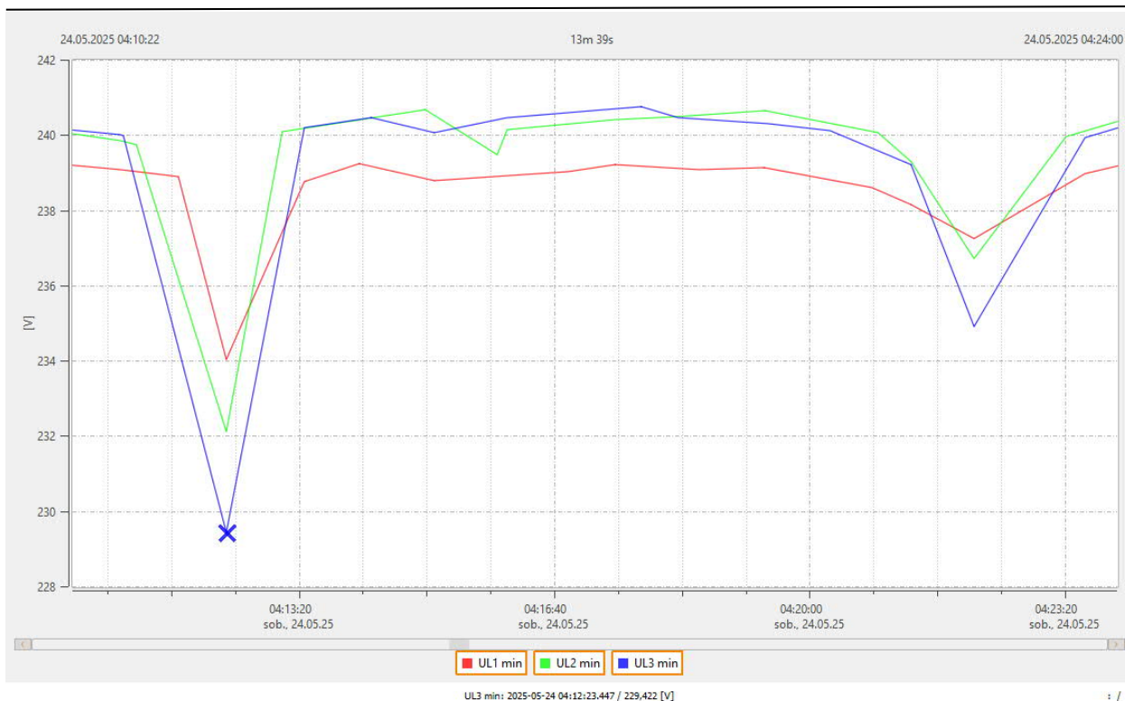
Rysunek 3: Spadek wartości napięcia w instalacji budynku harcówki
